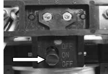
Превкл. за защита на диафр. - активиран. (Помпата няма да работи.)
