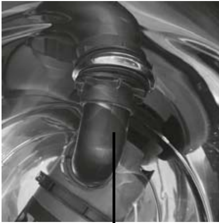
Der 90° Pumpen Anschluss
